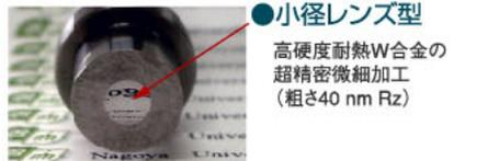
刃先に微小な楕円振動を与えながら、切削加工を行う新しい精密加工技術 (楕円振動切削加工法) を開発しました。さらに、これを応用して従来技術では困難であった各種高硬度材の超精密微細加工に挑戦しています。たとえば、電子光学分野では、光導波路やホログラム光学素子などの超精密微細構造をもつガラス素子の量産製造法の開発が、大きな課題でしたが、楕円振動切削法により、ガラス素子成形用のタンガステン合金製金型の超精密微細加工に世界で初めて成功しました。
