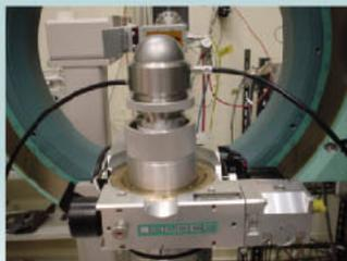
マイクロ構造体の構成要素である薄膜の内部応力分布を、X線回折法を用いて非破壊的に高精度で計測する手法を開発しました。また、EBSD（電子線後方散乱）およびAFM（原子間力顕微鏡）の複合解析により、薄膜材料の長期使用による疲労損傷をナノレベルで定量化できる計測法を確立しました。
